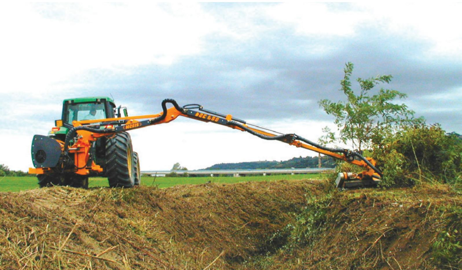
Decespugliatrice idraulica a braccio di 9 metri di estensione, per trattori di 150/200 HP e 7000 kg di peso, ideale per lavori di bonifica pesante e di sfalcio stradale, robusta, compatta, agganciata alta sul trattore e veloce nei movimenti.
